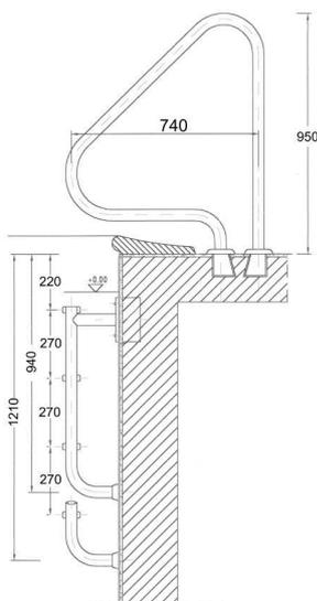
Scaletta modello GEMINA realizzata in acciaio Inox AISI 304, disponibili sia per piscine private che per piscine pubbliche, con montanti diametro 45 mm e spessore acciaio 1,5 mm. Le scalette GEMINA sono scalette in due pezzi con i montanti separati dai gradini, questo modello, più elegante, è particolarmente adatto a piscine dotate di pietre di bordo o griglia di sfioro
