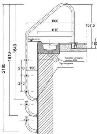
Scaletta modello FINLAND realizzata in acciaio Inox AISI 304, particolarmente indicate per piscine a sfioro, con montanti diametro 45 mm e spessore acciaio 1,5 mm. Grazie al loro interasse di 80 cm e alla speciale forma, oltrepassano la canalina di sfioro consentendo un accesso più comodo e sicuro.
