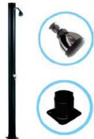
Doccia solare ad accumulo con altezza 215 cm, serbatoio da 18 lt e getto doccia orientabile. L'acqua proviene dal tubo di alimentazione, si riscalda rapidamente all'interno del serbatoio di PVC e mediante il miscelatore a corredo, è possibile usufruire di una doccia alla temperatura desiderata. Attacco ingresso acqua Ø 3/4" e connettore rapido.
