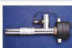
**SCAMBIATORI DI CALORE ELETTRICI** particolarmente studiati per il riscaldamento delle piscine fuoriterza, con involucro esterno in acciaio inox AISI 316 lucidato e resistenza Incoloy 825. Pressione massima di lavoro 3 bar, termostato regolazione 0-40° C, termostato sicurezza 55 ° C e flussostato
