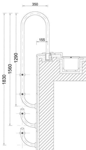
Scaletta modello ALLEMAND realizzata in acciaio Inox AISI 304, particolarmente indicate per piscine a sfioro, con montanti diametro 45 mm e spessore acciaio 1,5 mm. Grazie alla curva stretta del montante, vengono ancorate a valle della canalina di sfioro e vicine al bordo vasca.
