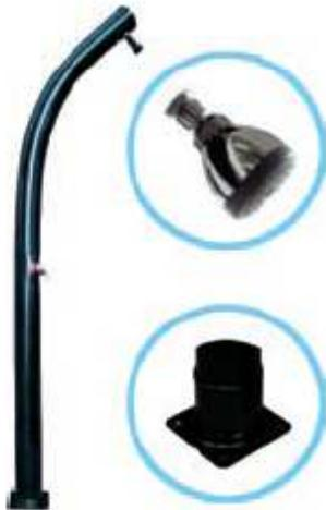
Doccia solare ad accumulo con altezza 230 cm, serbatoio da 20 lt e getto doccia orientabile. L'acqua proviene dal tubo di alimentazione, si riscalda rapidamente all'interno del serbatoio di PVC e mediante il miscelatore a corredo, è possibile usufruire di una doccia alla temperatura desiderata. Attacco ingresso acqua Ø 3/4" e connettore rapido.
